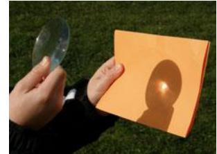
L'image d'un objet se trouvant à l'infini se forme dans le plan focal image.
