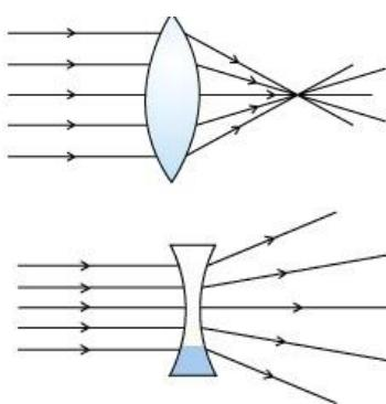
Une lentille à bords épais transforme un faisceau de rayons lumineux parallèles en un faisceau divergents immédiatement après la lentille: cette lentille est divergente.
