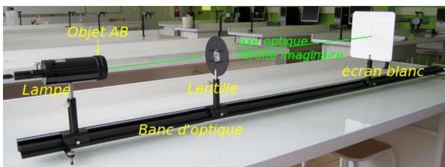
La lentille convergente étant fixe sur le banc optique, on déplace l'objet et l'écran de façon à obtenir une image nette. On réalise plusieurs mesures des distances  $p$  et  $p'$ .
